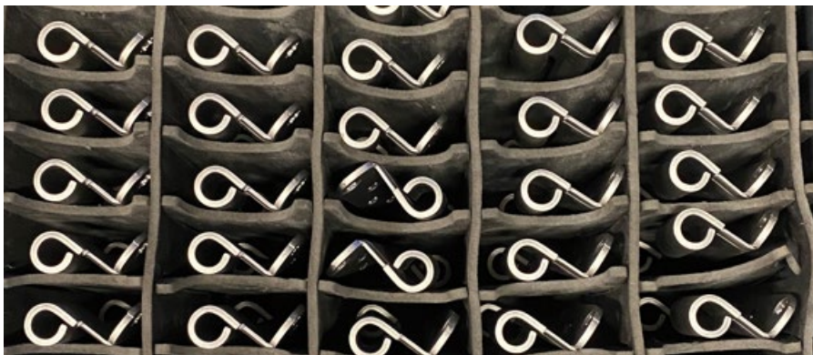
Teile in falscher Orientierung
