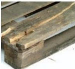
Un asse è rotto per il lungo / trasversalmente o consta di più pezzi.
